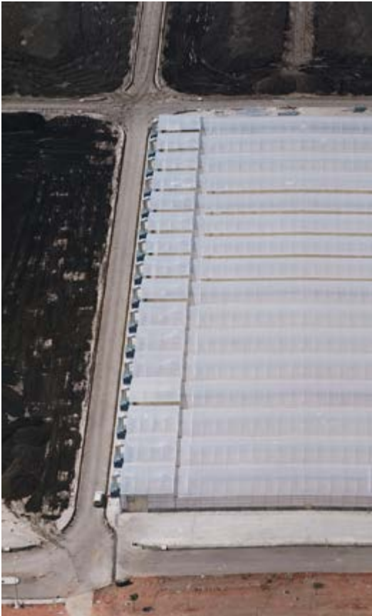
Instalación para secado de fangos de más de 8.000 m².
